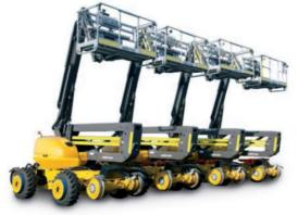
Auf mittlerweile allen fünf Kontinenten ist der SKY W16 im Einsatz. Damit ist er zur absoluten Referenz im Bereich der Zwei-Wege Arbeitsbühnen (MEWP) geworden. Die Verbindung zwischen dem von NEOTEC entwickelten Schienenfahrwerk sowie der von MANITOU entwickelten Arbeitsbühne ergeben zusammen eine absolut flexible und zuverlässige Arbeitsmaschine.
