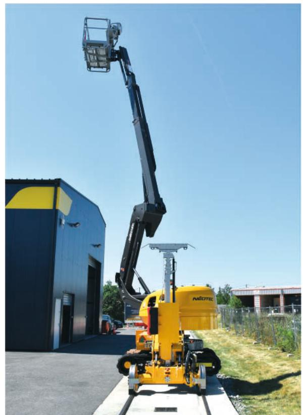
**Die Kinematik von Bras delta sorgt für eine vollständige Entfaltung der Arbeitsbühne, während sie den Bereich des Fahrdrachts umgeht.**
