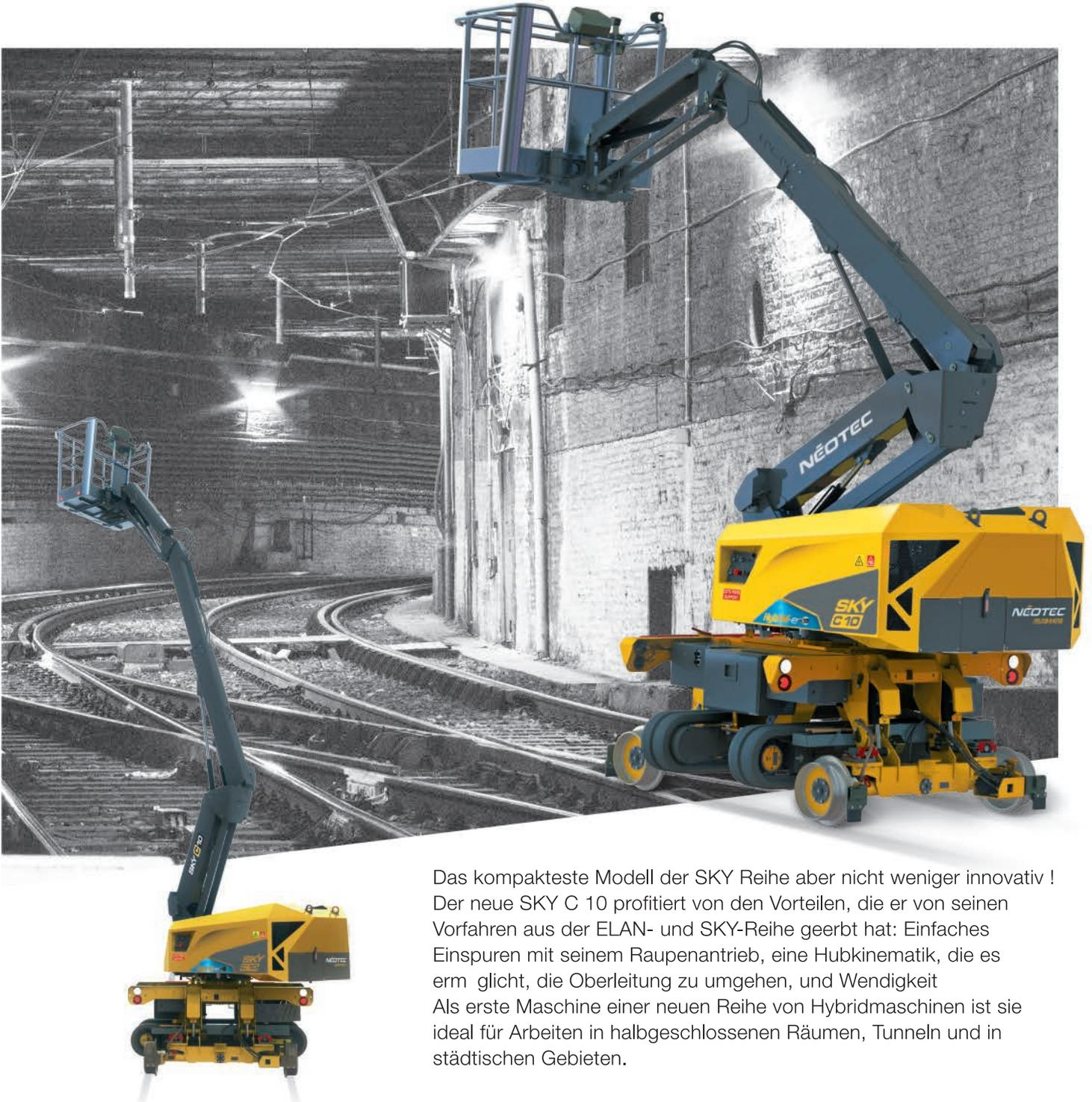
Das kompakteste Modell der SKY Reihe aber nicht weniger innovativ ! Der neue SKY C 10 profitiert von den Vorteilen, die er von seinen Vorfahren aus der ELAN- und SKY-Reihe geerbt hat: Einfaches Einspuren mit seinem Raupenantrieb, eine Hubkinematik, die es ermöglicht, die Oberleitung zu umgehen, und Wendigkeit. Als erste Maschine einer neuen Reihe von Hybridmaschinen ist sie ideal für Arbeiten in halbgeschlossenen Räumen, Tunneln und in städtischen Gebieten.
