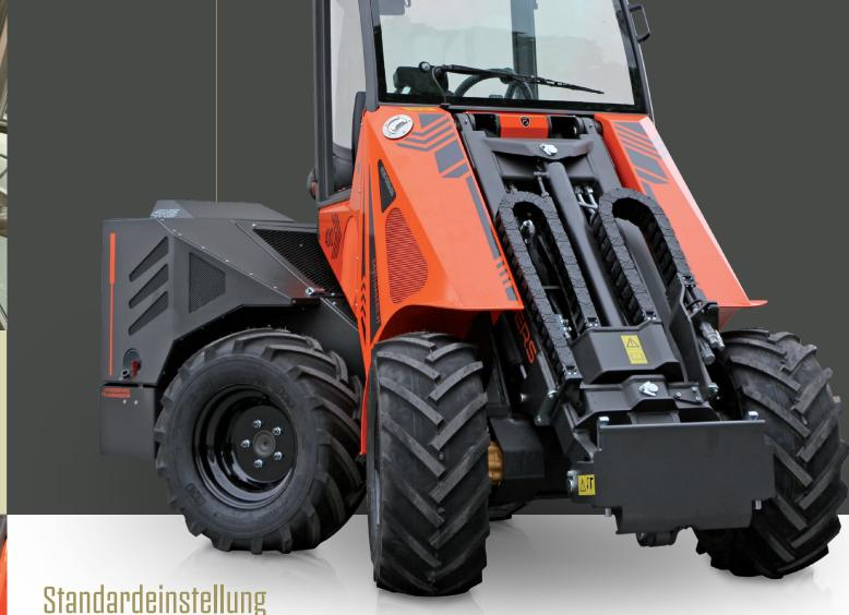
Motor Yanmar Stage V /38 Ps | Geschwindigkeit 16 Km/h | Hydrostatischer Fahrantrieb -4WD | Elektrische Differenzialgetriebe Wasser Kühlung | Parallelführung | Zusatzhydraulik 66 l/min | Gelenkfahrgestell mit 4 Lenkräder | 11-fach Joystick (15-fach option)
